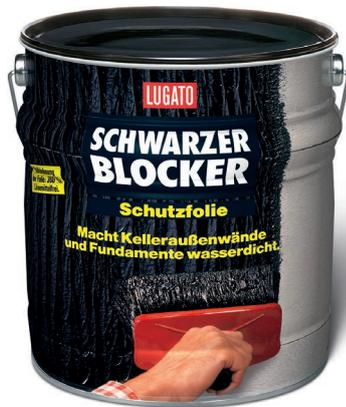
Die flexible Streichabdichtung gegen Bodenfeuchtigkeit. Wird beim Trocknen zu einer hochelastischen, wasserdichten Folie. Reißdehnung von 300 %.
